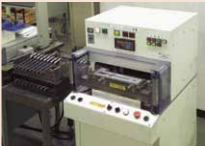
ABS 방수 캘리퍼스용 공기 누출 시험 장비
